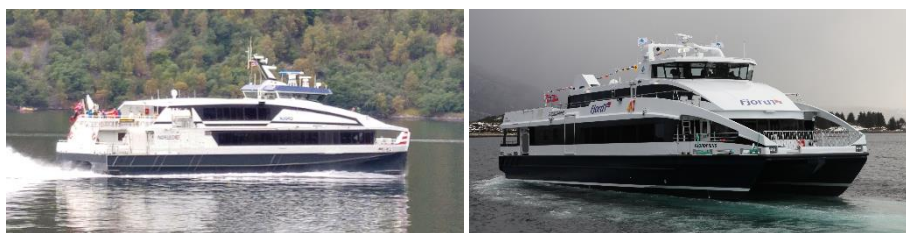
Figur 2: Hovedalternativer for større hurtigbåter. Skrog i aluminium (Norled sin MS Njård t.v.) eller karbonfiber (MS Fjordprins t.h., tidl. eier/foto: Fjord 1).
