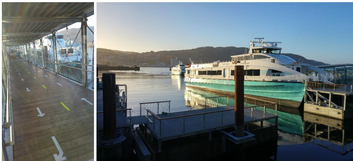
Figur 8: Hurtigbåtleier med mulighet for separat ombord- og ilandstiging i Trondheim. Hurtigbåter (Fosen-Namsos sjø) med enkel nedfellbar gangveg forut og på begge sider akter.
