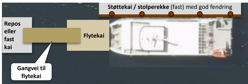
Figur 9: Flytekai/støttekai for mindre anløpssteder. Ombord- og ilandstiging forut.
