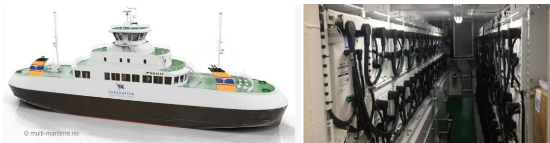
Figur 15: Torghattan Nord har i mars 2016 kontrahert verdens første ladbare hybridfergeferge (biodiesel), illustrasjon t.v. Multi Maritime AS, Førde. I Finland er det prosjektert en hybridferge med hurtiglading. T.h. batteribank i hybridferga MF Fannefjord på Molde-Vestnes. Foto: Fjord 1.
