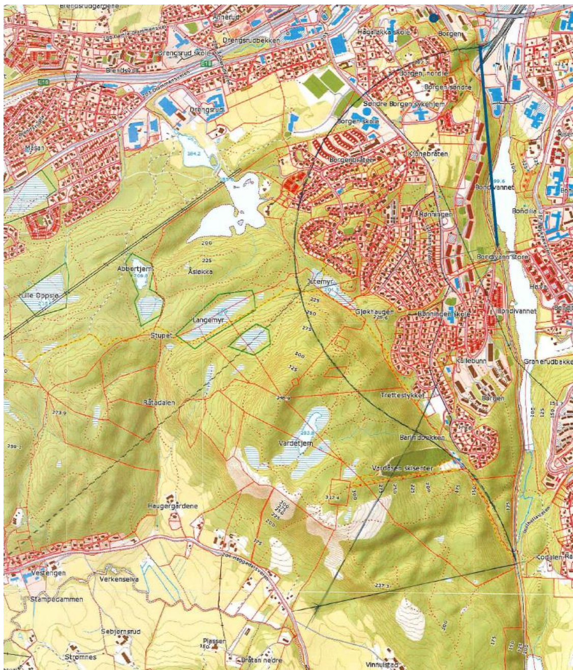
Figur 5 Skitse for niveaufri indføring af Spikkestadbanen til den nye Askerbane med 130 km/t, hvor den skitserede linjeføring er baseret på radius 1000 og en overhøjde på 100 mm.
